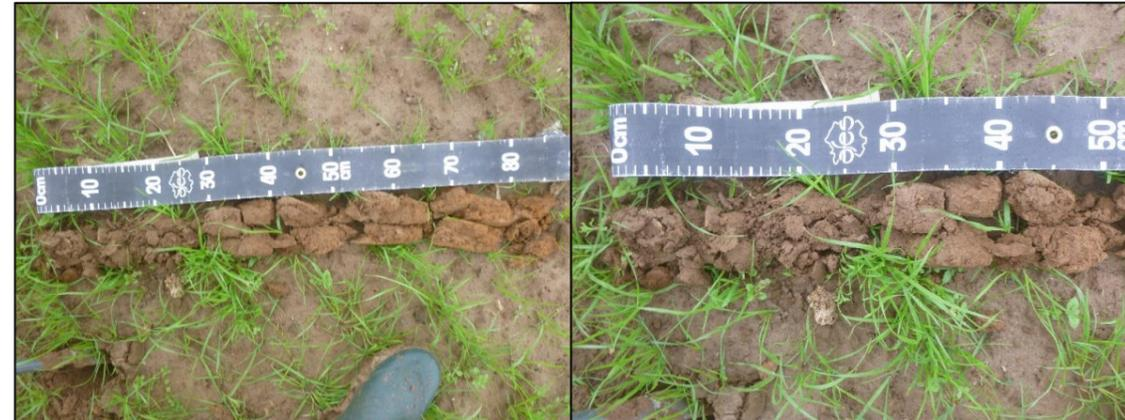
**Figure 84 : Sondage n°10, avec refus de tarière lié au calcaire à 50 cm**
